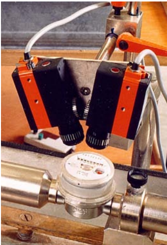
Abb. 1: Jeder Wasser- und Wärmezähler wird bei der Eichung auch einzeln auf seine Funktionsfähigkeit geprüft.
