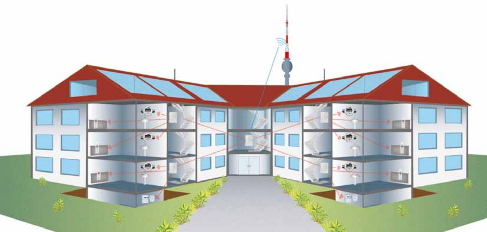
Minol Funksystem radio 9 in seiner Ausprägung als Datensammler-Netzwerk
