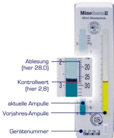
Wer als Wohnungseigentümer oder Mieter selbst eine Kontrollablesung durchführt, dem wird empfohlen, eine Taschenlampe zu verwenden. Indem die Flüssigkeitssäule von unten beleuchtet wird, ist die Ablesemarke leicht erkennbar.
