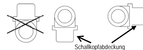
Abb. 6: Empfohlene Einbaulage bei Kältezählung
