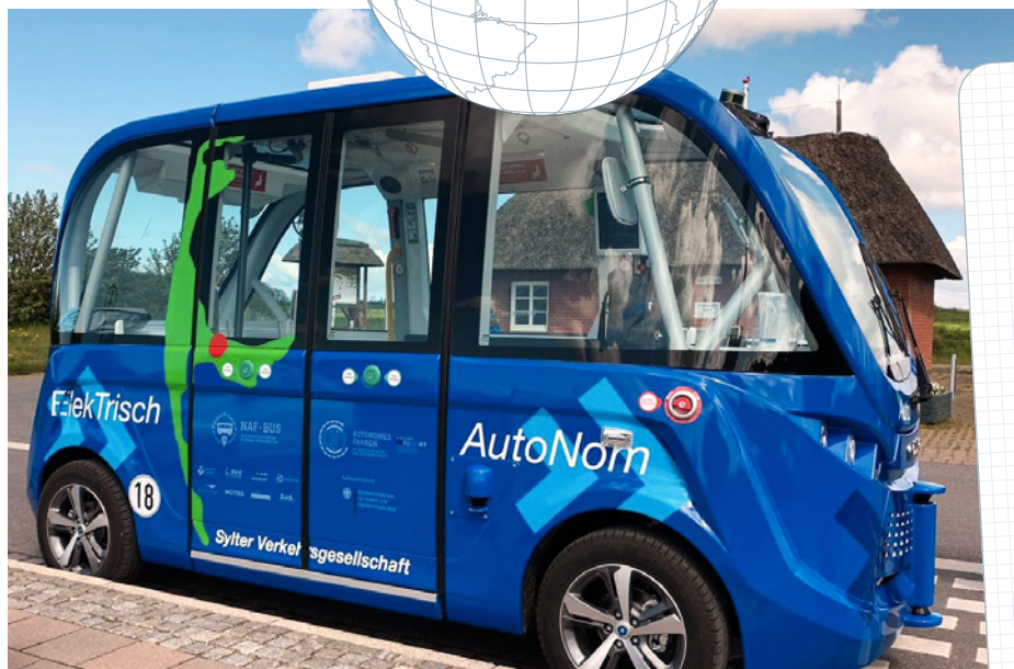
Der NAF-Bus fährt autonom und vollelektrisch.
