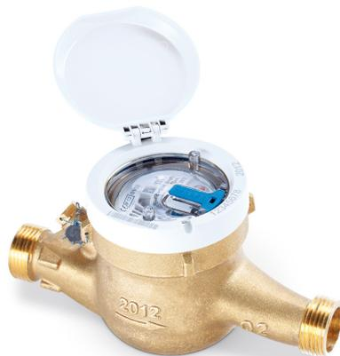
Die Mehrstrahl-Flügelradzähler als Nassläufer gibt es, je nach Situation und Rohrführung, sowohl in Ausführungen für den horizontalen, als auch für den vertikalen Einbau. Das verschleißfeste und gut ablesbare Rollenzählwerk sitzt in einem WVG-Gehäuse. Eine hohe Messgenauigkeit und Zuverlässigkeit in allen Belastungsbereichen über die gesamte Dauer der Eichgültigkeit sind selbstverständlich.
