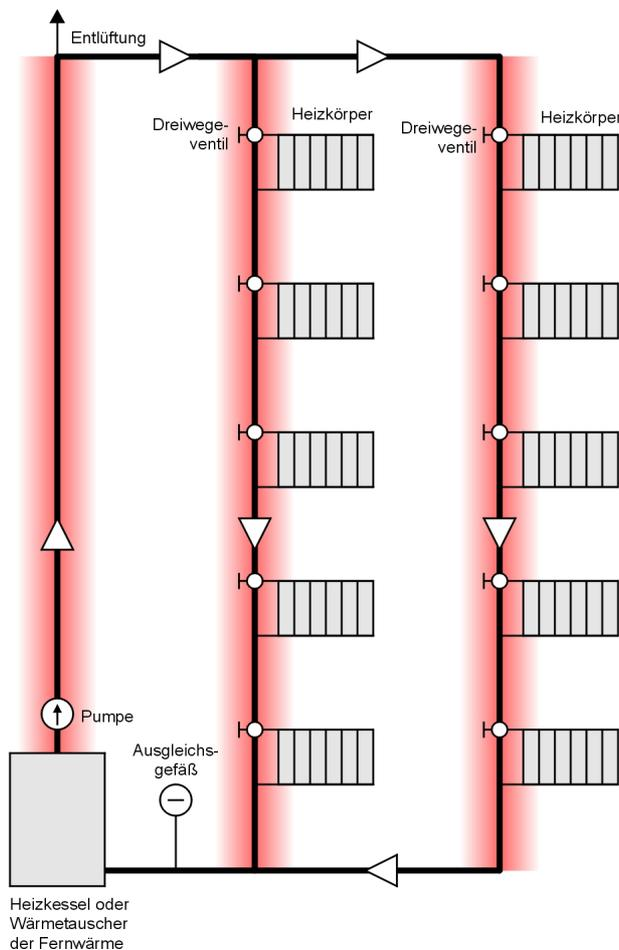
Das Prinzip der senkrechten Einrohrheizung. Bei hohen Vorlauftemperaturen und schlecht isolierten Rohrleitungen wird zu viel Wärme abgegeben und die Heizkörper müssen gar nicht benutzt werden.
