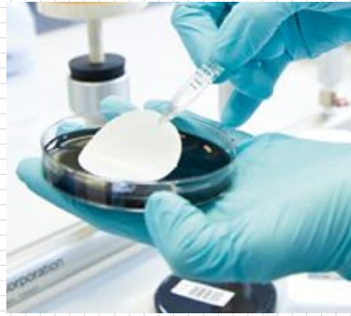
Sind Legionellen vorhanden, bleiben sie auf dem Filter zurück, der auf einen Nährboden aufgelegt wird.
