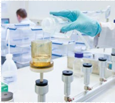
Jede Wasserprobe wird mit zwei unterschiedlichen Verfahren analysiert. Ein Teil wird zunächst gefiltert.
