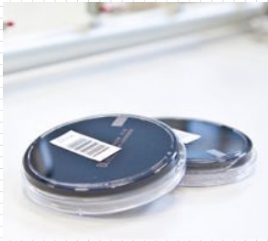
Beide Proben lagern nun 10 Tage lang bei konstant 37 Grad – optimale Bedingungen für die Vermehrung der Legionellen.
