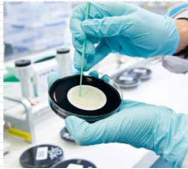
Die Filteranalyse der Wasserprobe zeigt einen deutlichen Befund: Die gelben Punkte sind Legionellenkolonien.
