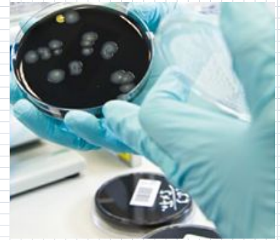
Grenzwert überschritten: Der zweite Analyseansatz bestätigt das Ergebnis und zeigt deutlich mehr als eine KBE pro ml.
