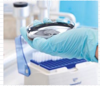
Beim zweiten Verfahren wird 1 ml der Wasserprobe direkt auf einen Nährboden aufgetragen.
