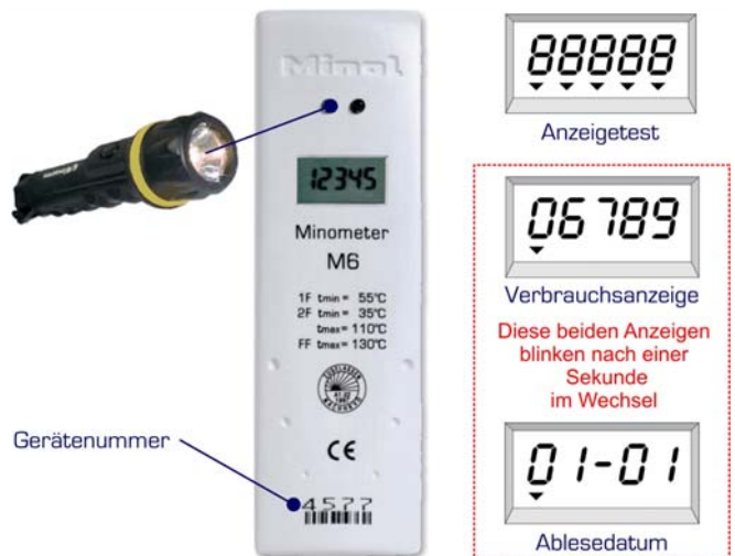
Abb. 7: Ablesung der elektronischen Heizkostenverteiler Minometer M5-M7.
