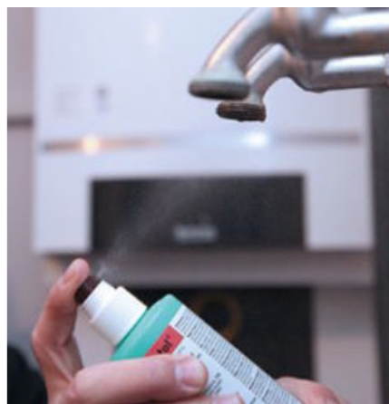
Abb. 1-3: Bei geeigneten Entnahmestellen werden mögliche Keime durch Abflammen beseitigt. Ist das nicht möglich, werden Keime durch ein entsprechendes Spray abgetötet. Erst dann wird eine fest definierte Probenmenge genommen-
