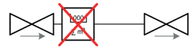
Abb. 2.4 Ein Durchflusssensor darf nicht unmittelbar nach einem Ventil eingesetzt werden. Quelle: DIN CEN TR 13582:2021
