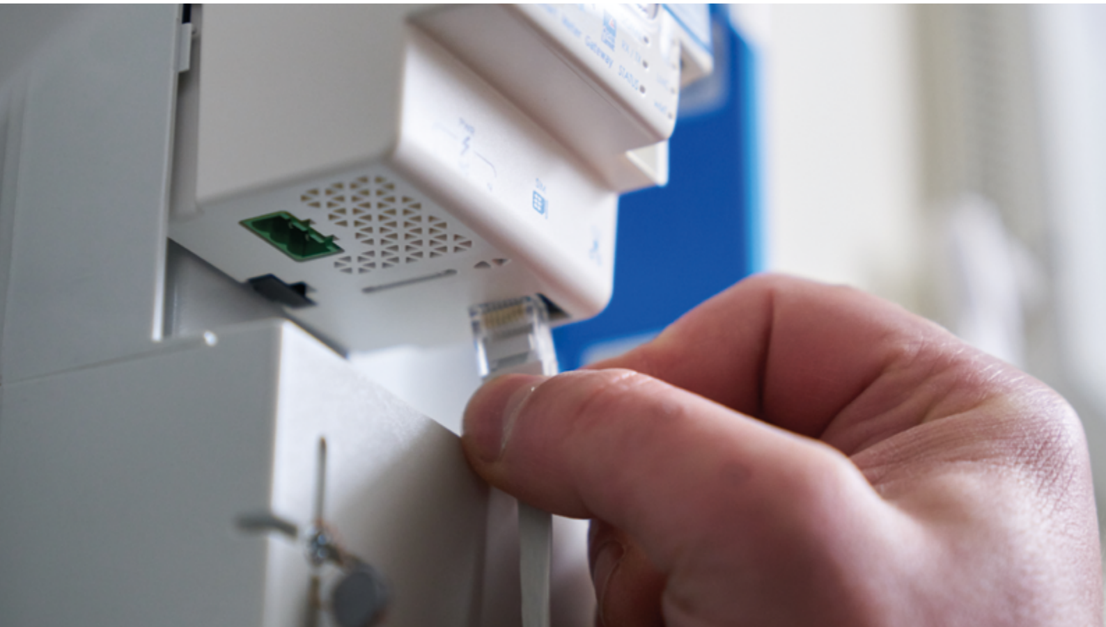
Anbindung eines Minol IoT gateways indoor an ein Smart Meter Gateway
