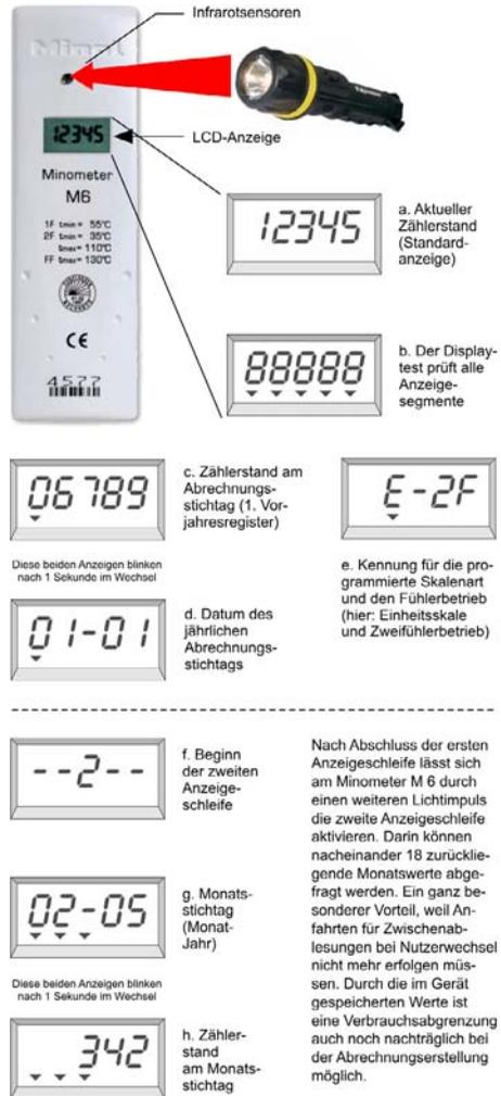
Abb. 12: Ablesung des elektronischen Heizkostenverteilers Minometer M 6.
