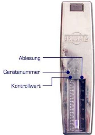
Abb. 13: Ablesung eines Warmwasserkostenverteilers.
