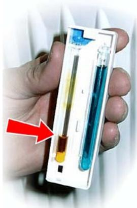
Abb. 10: Ansicht der eingelegten Vorjahresampulle von der Rückseite.
