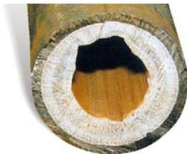
Abb. 2: So sieht eine Warmwasserleitung nach mehreren Jahren aus, wenn keine besonderen Maßnahmen ergriffen wurden, um Verkalkung zu verhindern.
