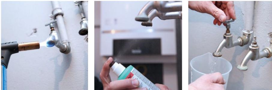
*Bei geeigneten Entnahmestellen werden mögliche Keime durch Abflammen beseitigt. Ist das nicht möglich, werden Keime durch ein entsprechendes Spray abgetötet. Erst dann wird eine fest definierte Probenmenge genommen.*
