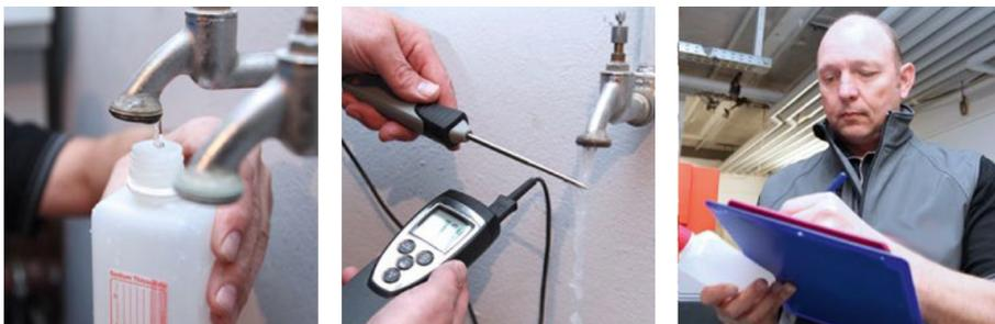
*Vor dem Versand ins Labor erfolgt die Abfüllung der Wasserproben in keimfreie Behälter. Im Probenentnahmeprotokoll wird neben der Entnahmestelle auch die Wassertemperatur eingetragen.*
